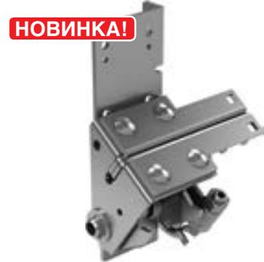
■ **Устройство защиты от разрыва троса с регулировкой натяжения** устанавливается в качестве нижнего кронштейна на полотно ворот. В случае обрыва троса механизм срабатывает и не дает воротам упасть.
