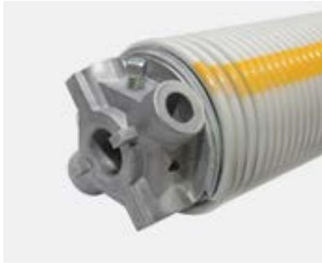
■ **Порошковое покрытие пружин** Для улучшения механических свойств торсионных пружин диаметром 95 и 152 мм используется специально подобранная краска. Покрытие пружин выполнено в два слоя: первым нанесен цинк, вторым — порошковая краска.
