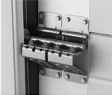
■ **Усиленные боковые опоры** устанавливаются на ворота серии ISD01, перекрывающие большие проемы, для увеличения прочности и надежности конструкции. Центральный паз обеспечивает наиболее точное позиционирование держателя ролика.
